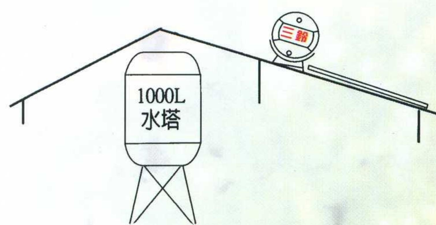
耐壓桶強制熱循環型
